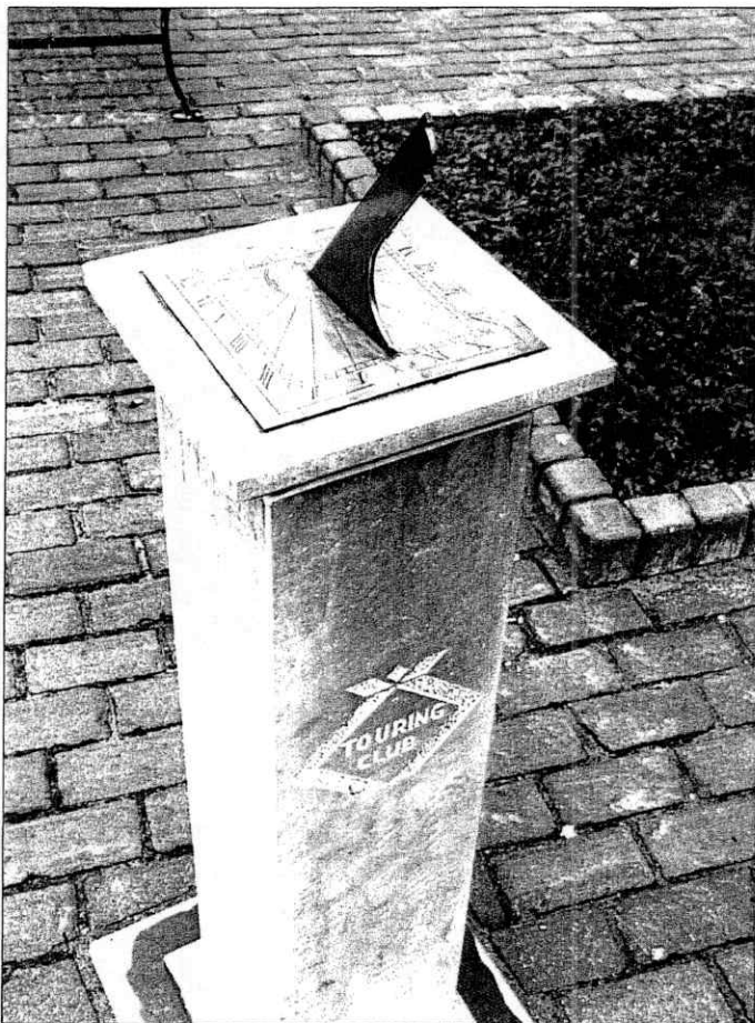
Vakkundig gegraveerde koperen horizontale zonnewijzer.
